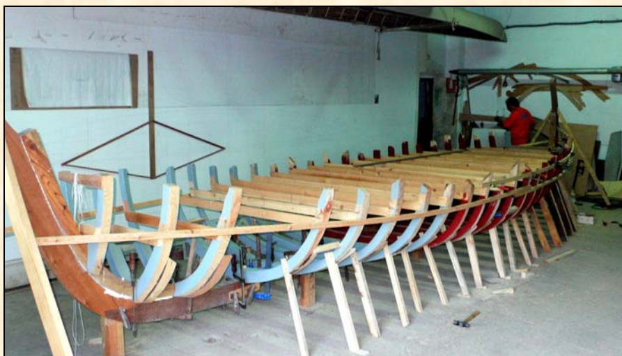
Construcción de la barca de jábega Araceli. Los planos están sobre la pared. Astilleros Nereo de Málaga. 2008. (Foto F.F.)
