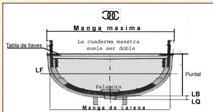
Perfil transversal de una barca. (Cuaderna maestra)
